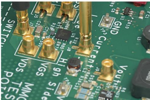
IsoVu 探棒頭具有可提供高效能和配件的連接和配件範圍。探棒可以直接連接至 MMCX 接頭，價格便宜且能廣泛使用。這可造成穩定且不需人工操作的測試點，並提供高頻寬和共模互斥。實心金屬體會屏蔽中心導體，並盡可能最小化接地迴路區域的最低干擾。
