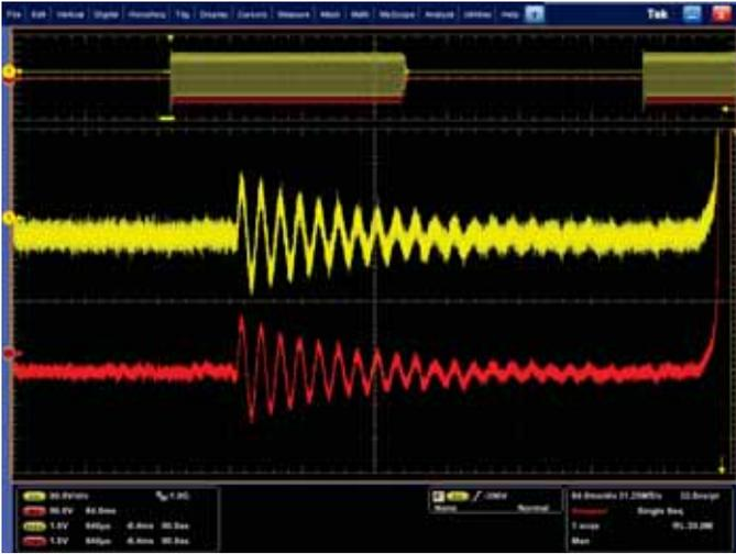
擷取 - HiRes 擷取 - 增加垂直解析度為 >11 位元，同時消除 650 V Pk-Pk 訊號上的雜訊，並查看包含或不包含套用低通濾波且低於 1 V Pk-Pk 的更小細節。
