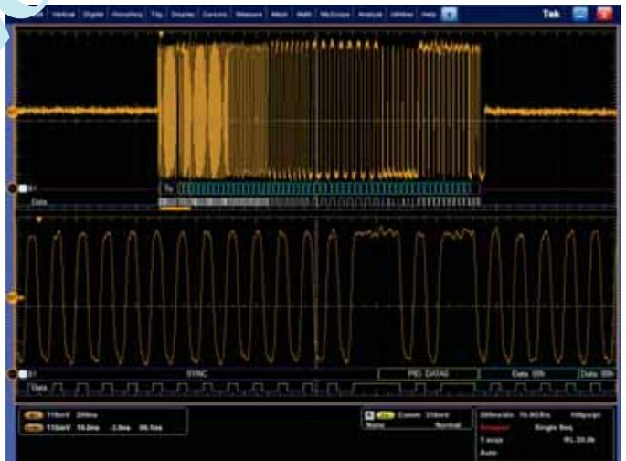
USB 全速串列匯流排觸發。匯流排波形提供解碼封包內容，例如起始、同步、PID、位址、終點、CRC、資料值與停止。
