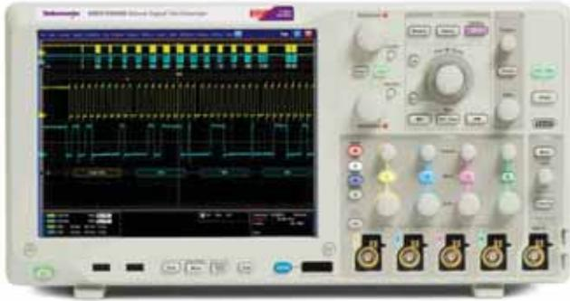
設計現今更快速的資料率及更密集的時序邊際，需要配備出色訊號擷取效能及分析能力的示波器。Tektronix MSO/DPO5000B 系列示波器提供絕佳的訊號保真度，配備 2 GHz 頻寬和 10 GS/s 取樣率，外加進階分析與運算能力，適合在工作台及實驗室中使用。在示波器上可執行 Windows® 架構的分析軟體。指向並點選視覺觸發就能輕鬆擷取複雜的訊號。MSO 機型含有 16 個數位時序通道，而所有機型皆可配備該通道以解碼常用的串列通訊協定，為您的系統提供全方位的檢視功能。
