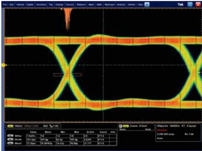
分析 - 622 Mb/s 訊號的上升及下降邊緣波形長條圖，顯示邊緣位置 (抖動) 隨時間經過的分布。包含在波形長條圖資料上進行的數字量測。
