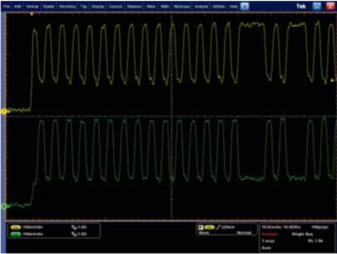
效能 - 利用高達 2 GHz 頻寬和 10 GS/s 取樣率擷取含真實保真度及 100 ps 解析度的 USB2.0 480 Mb/s 差動訊號。
