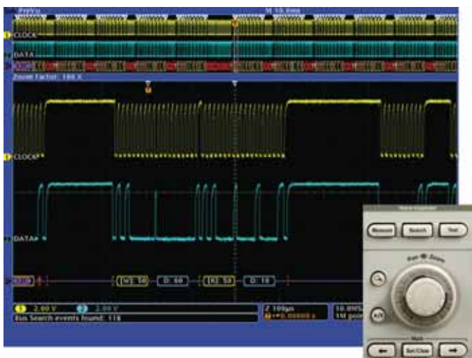
搜尋 - PC 的解碼功能，顯示「位址」值 50 的 Wave Inspector 搜尋結果。Wave Inspector 控制項提供前所未有的檢視與瀏覽波形資料的效率。
