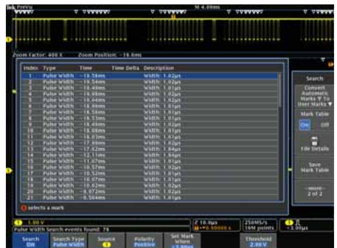
搜尋步驟 3：搜尋標記表提供了每個由自動搜尋所找到的事件的表格視圖。每個事件都顯示帶有時間戳記，可輕鬆在事件之間進行時序量測。
