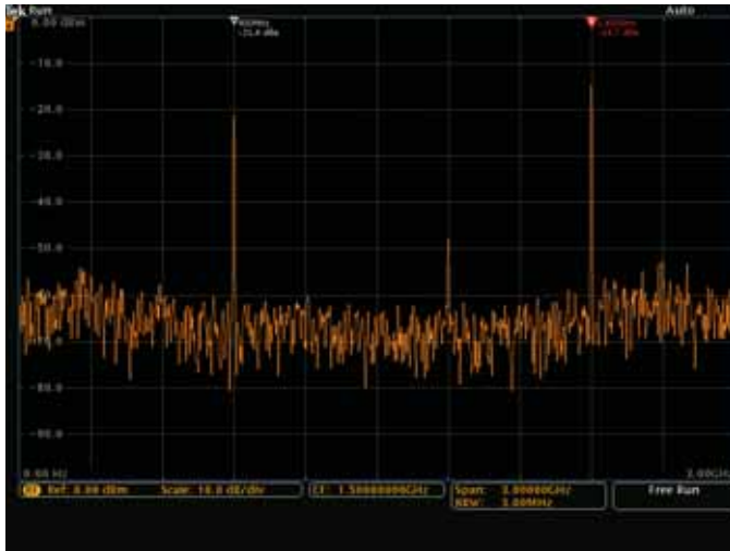
突波通訊的頻譜顯示，在 900 MHz 時透過 Zigbee 傳入裝置；在 2.4 GHz 時透過藍牙傳出裝置 (單次擷取中擷取)。
