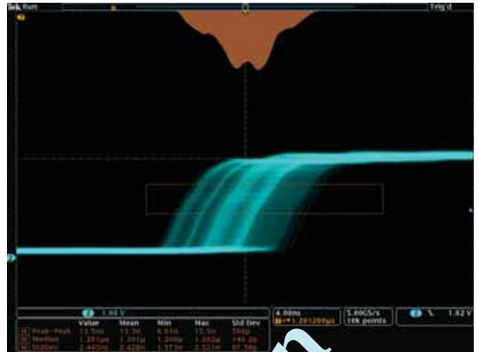
上升邊緣的波形直方圖表示邊緣位置（抖動）隨時間的分佈。包含在波形長條圖資料上進行的數字量測。
