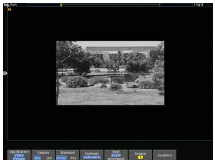
檢視 NTSC 視訊訊號。視訊圖像模式包含了自動對比度和亮度設定以及手動控制。
