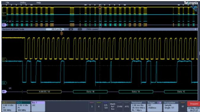
觸發通過 I<sup>2</sup>C 匯流排的特定位址和資料封包。黃色波形表示時脈，藍色波形表示資料。匯流排波形提供解碼封包內容，包括開始、位址、讀取/寫入、資料和停止。
