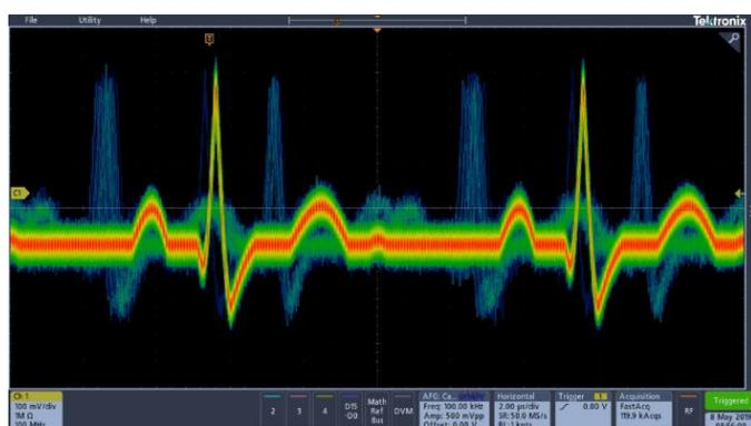
數位螢光技術搭配 FastAcq 可產生 280,000wfms/s 的波形擷取速率和即時色彩強度分級。
