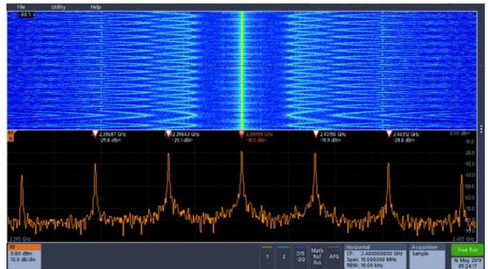
頻譜圖畫面說明緩慢變化的射頻現象。如圖所示, 示波器正在監測擁有多個峰值的訊號。當峰值的頻率與振幅隨時間變化時, 在頻譜圖畫面中可輕易地看到變化。
