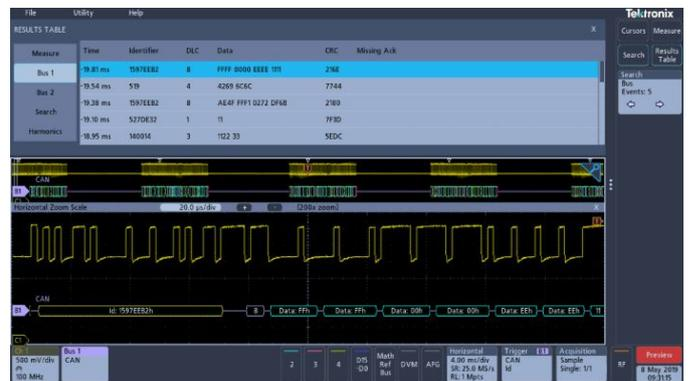
事件表顯示長擷取中每個 CAN 封包的解碼識別碼、DLC、DATA 與 CRC。
