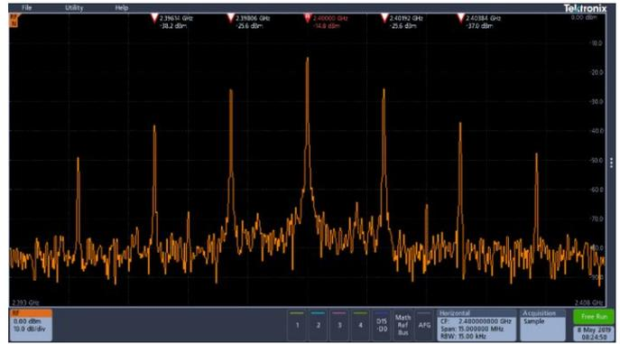
自動峰值標記可一目瞭然地識別關鍵資訊。如圖所示, 五個符合臨界值與偏差值條件的最高振幅峰值, 以及每個峰值頻率和振幅會自動標記出來。
